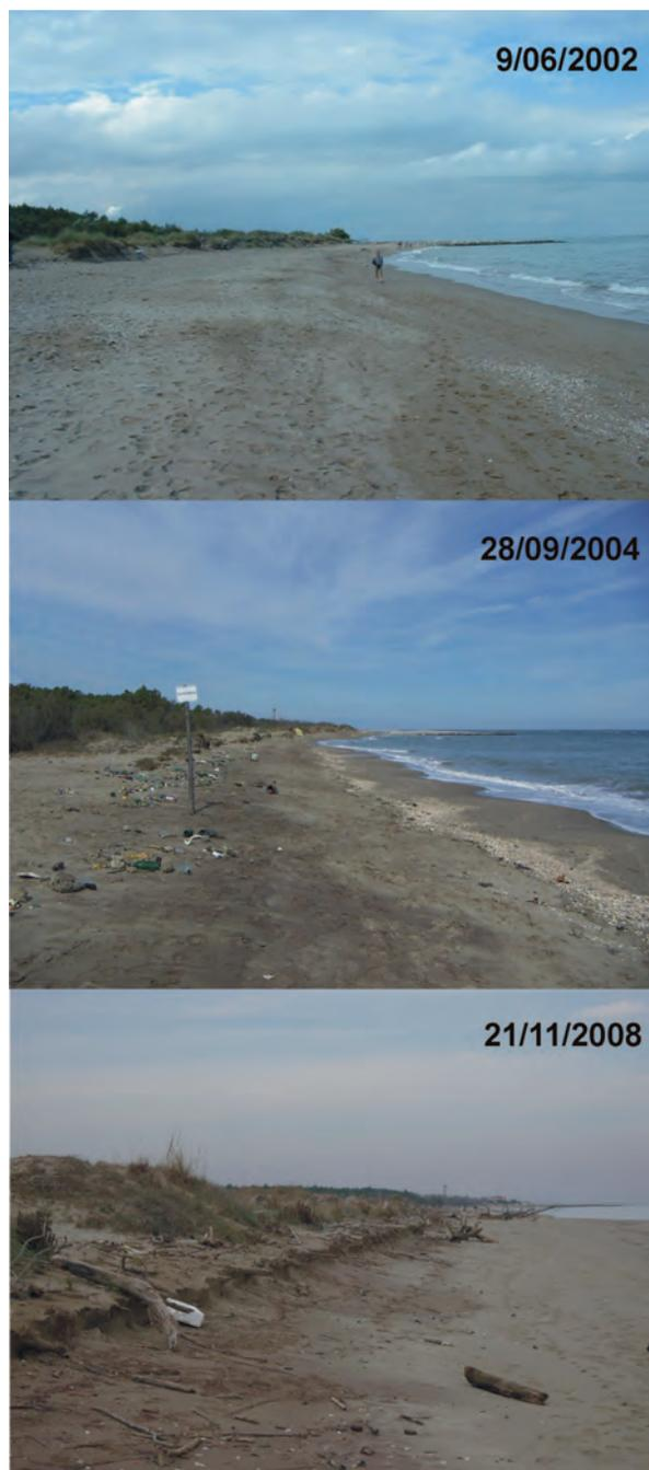
Figura 14 - Sequenza di fotografie riprese ad una distanza di 500 a Sud delle opere nel periodo 2002-2008. Si può notare che con il passare degli anni la vegetazione dunale è sempre più danneggiata dal salt-spray. Nel 2008 la cresta della duna è in pratica inesistente e le dune stabilizzate iniziano ad essere erose.
