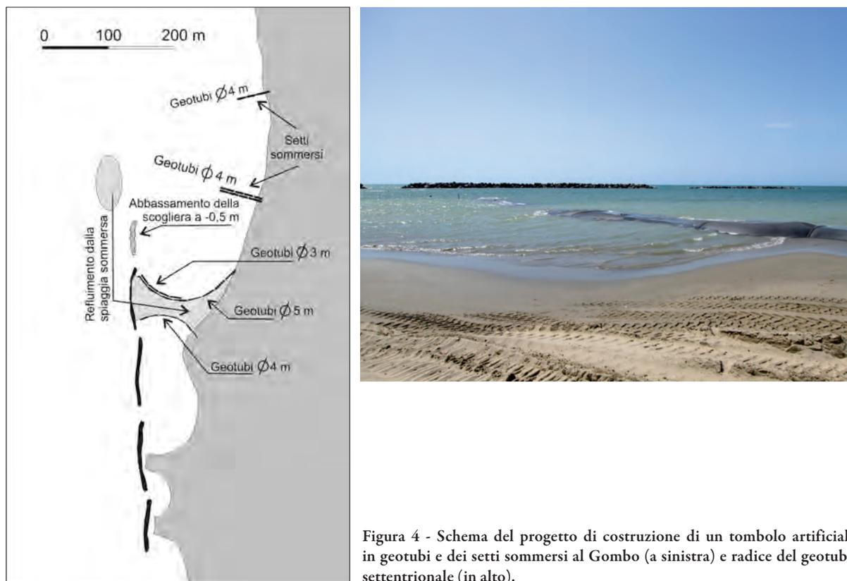
Figura 4 - Schema del progetto di costruzione di un tombolo artificiale in geotubi e dei setti sommersi al Gombo (a sinistra) e radice del geotubo settentrionale (in alto).
