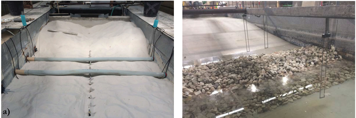
Figura 2. (a) Sistema di drenaggio posizionato all'interno della spiaggia, (b) Barriera sommersa.
