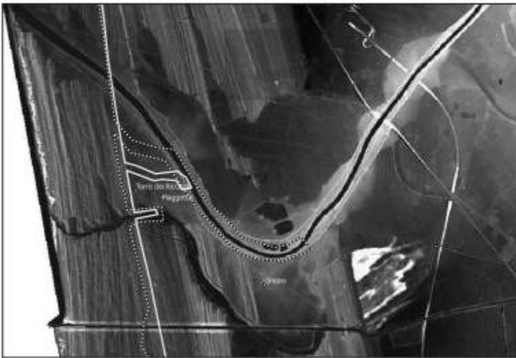
Figura 11. Le colmate di Oncino e Piaggetta e il progetto di rettificazione del Fiume Morto, Stefano Piazzini (1780 ca.) e le tracce del taglio del XVI secolo, SASP, Piante dell'ufficio Fiumi e Fossi, 158 (a); il DTM (ADBS, 2006) in cui sono evidenziate le foci e le linee di costa di inizio (bianco) e fine (tratteggio) XVII secolo (b).
