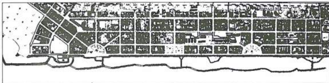
Figura 1a - Configurazione delle opere di difesa di Marina di Pisa (scogliere emerse in nero e sommerse in bianco).
