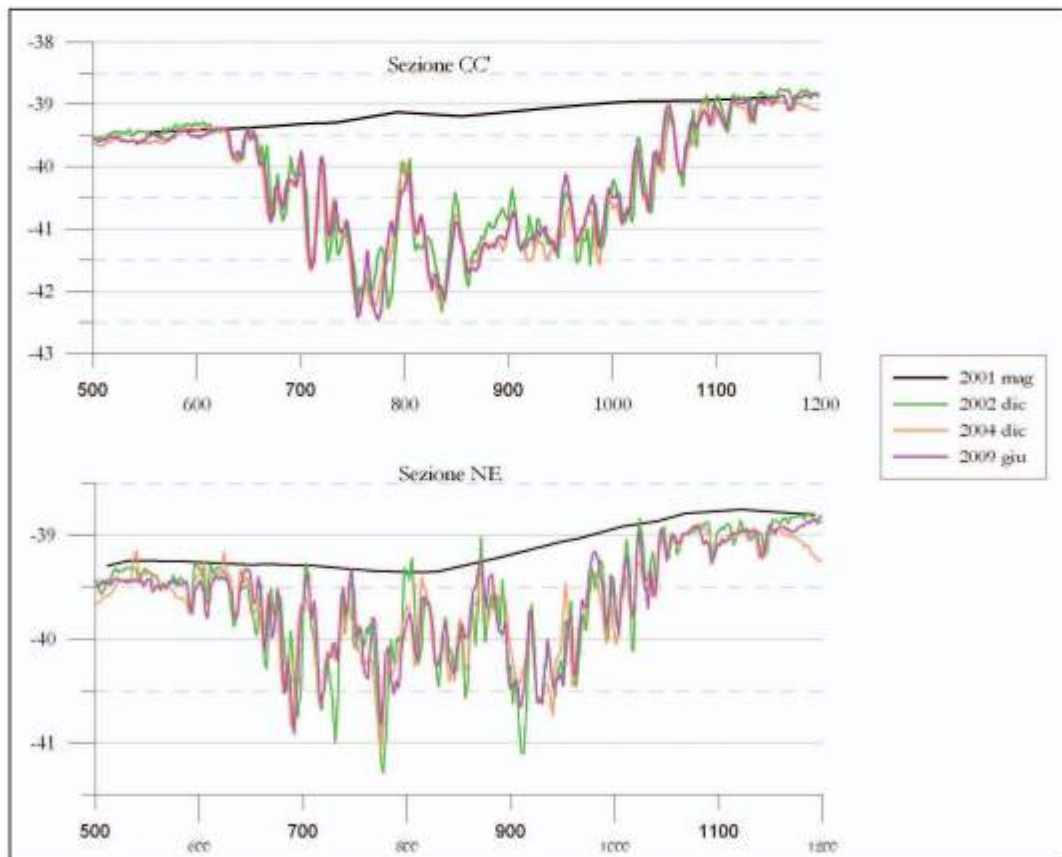
Figura 8 – Area C1P02: confronto tra i profili del fondale in corrispondenza delle sezioni CC (in alto) e NE(in basso). L'ubicazione delle tracce di sezione è riportata in Figura 5.
