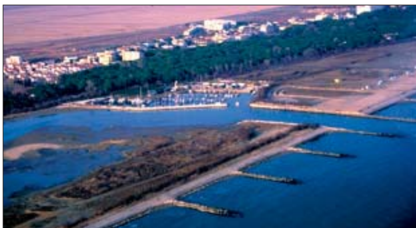
Bocca armata della piccola Laguna del Mort formatasi a seguito di una piena del Piave.
