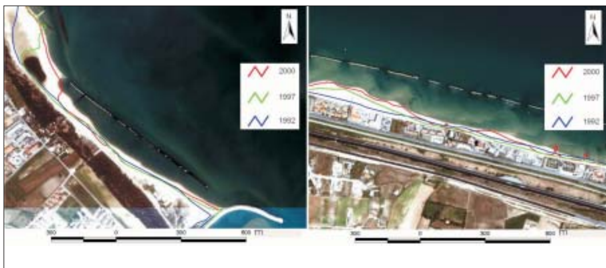
Evoluzione recente della linea di riva in seguito alla realizzazione di scogliere emerse e pennelli lungo la spiaggia di Campomarino (a) e sul litorale settentrionale di Termoli (b).
