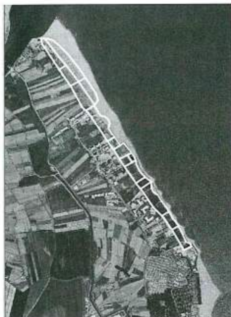
Figura 3 - Esempio di estrazione delle entità vettoriali (poligoni) corrispondenti alle aree occupate dai cordoni dunari costieri.
