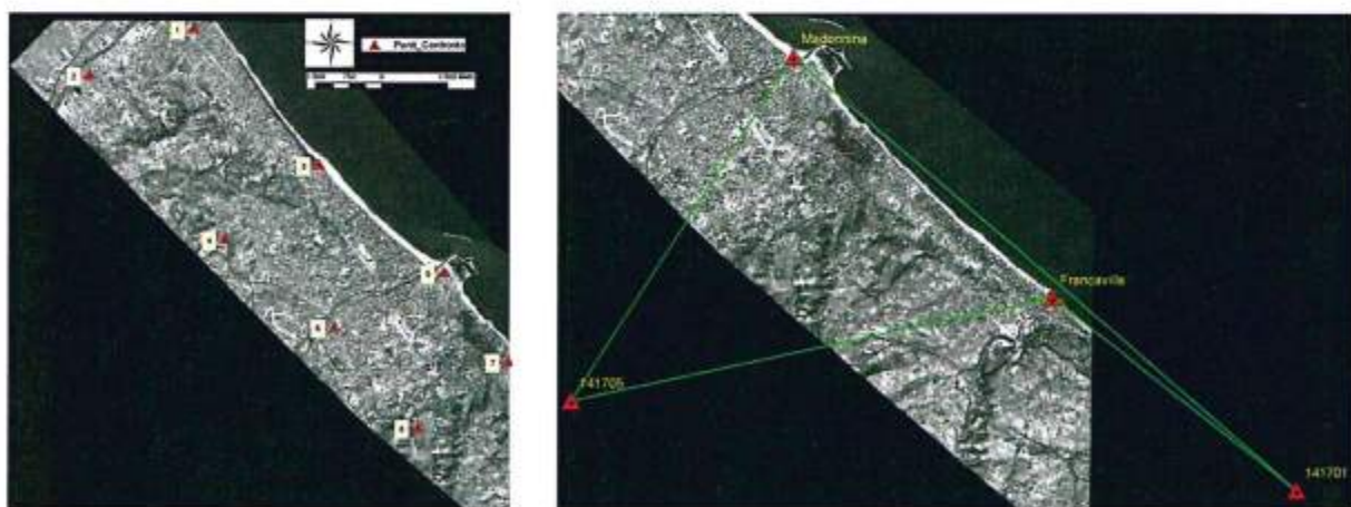
Figura 4 - Dislocazione dei punti rilevati e schema dell'inquadramento del rilievo nella rete IGM95.
