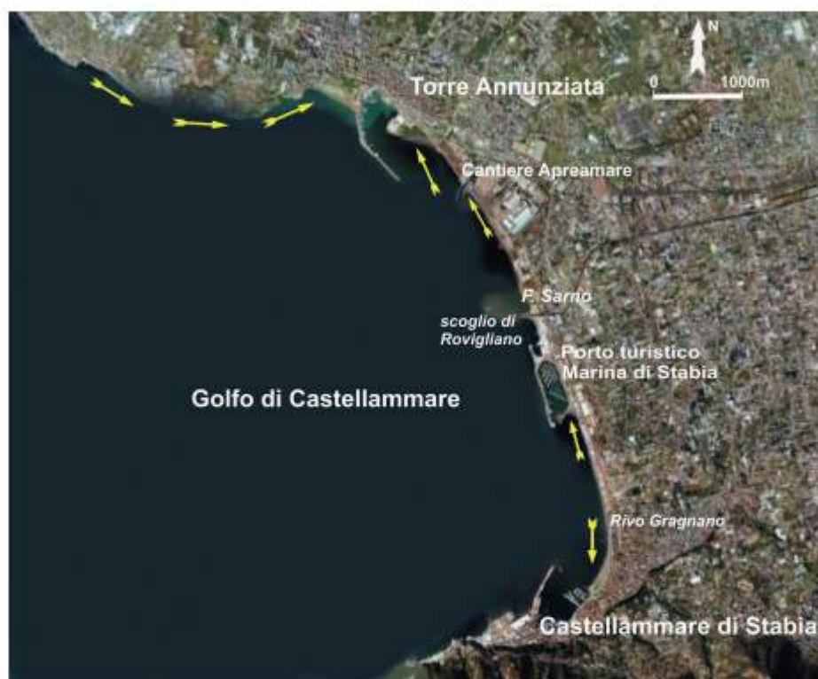
Figura 12 - Deriva litoranea (freccia gialla) ricostruita in base alle evidenze morfologiche rese manifeste dalla progradazione delle spiagge.
