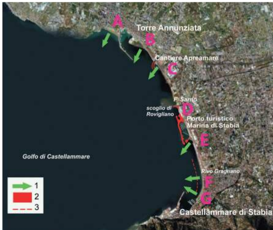
Figura 7 - Progradazione delle spiagge, rilevata nell'agosto del 2008, per effetto degli interventi antropici (rilievo satellitare del 2007); le lettere maiuscole nella figura rimandano alle foto ravvicinate delle aree citate nel testo e presentate nella figura seguente: 1 - spiagge in avanzamento; 2 - opere a difesa del cantiere e della darsena Apremare, molo guardiano alla foce del F. Sarno e porto Turistico Marina di Stabia (a partire dal 2000 ca.); 3 - barriere soffolte.
