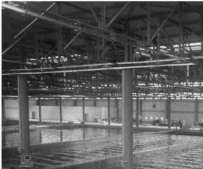
Figura 3 - Bacino con ondogeno in dotazione al Laboratorio di Ricerca e Sperimentazione per la Difesa delle Coste del Politecnico di Bari (lungo 90 m, largo 50 m e profondo 1.2 m) in cui è possibile riprodurre fronti d'onda anche di 30 m.
