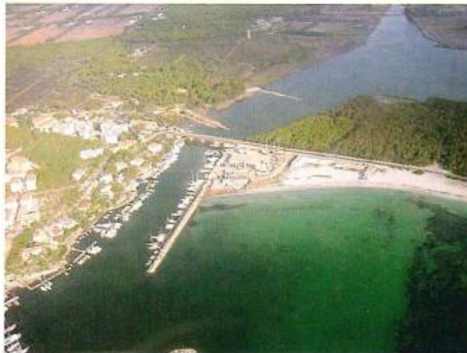
Figura 3 - Panoramica della bocca a mare dello Stagno del Calich, presso Fertilia, dove è evidente l'accumulo delle sabbie sul molo di Ponente del porticciolo turistico.
