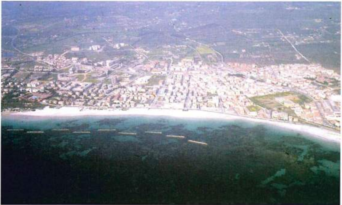
Figura 2 - Particolare della spiaggia di Alghero, si può osservare il punto di più intensa attività erosiva del settore "artificiale" protetto dalle 9 barriere a mare e dalla barriera parallela a difesa dell'ospedale marino.
