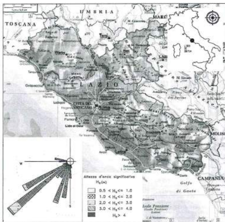
Figura 1 - Posizione del Lido di Ostia e distribuzione direzionale del moto ondoso (dati rilevati dalla boa CONDRA COS su fondale di -12 m dal 01.01.1990 al 31.12.1992).
