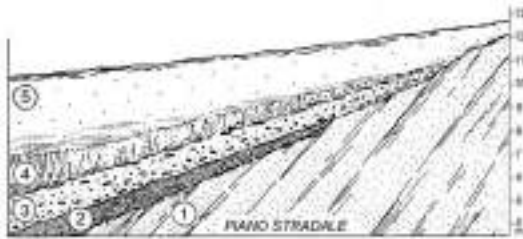
Figura 63 – Piccola sezione visibile in sinistra del F. º Emissario dell'ex Lago di Rimigliano (oggi bocca settentrionale del F. º Allacciante) in vicinanza della Punta del Molino. 1 – Arenaria Macigno dell'Oligocene del Dominio Toscano; 2 – Sabbia grossolana rossa, colluviale; 3 – Sabbia grossolana e fine con clasti sparsi, colluviale; 4 – Calcarenite sabbiosa (... di Biserno) con concrezioni intrasedimentarie verticali e fossili marini; 5 – Sabbie di Donoratico con laminazione incrociata alla base (da Mazzanti et al. 1981).
