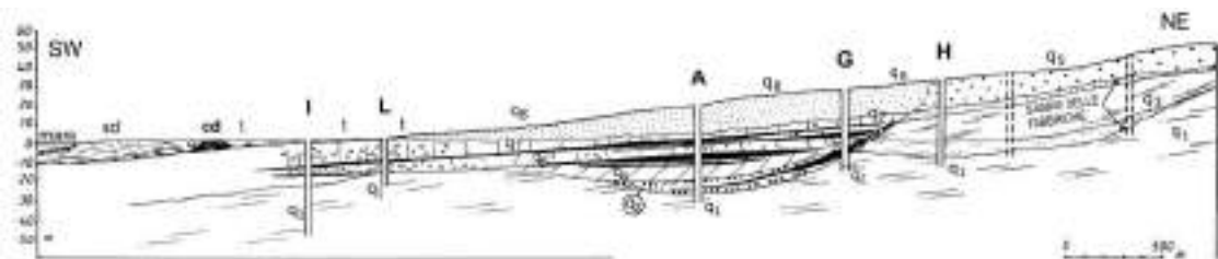
Figura 56 - Sezione geologica attraverso la pianura olocenica, il T. ººº II e il T. ººº I a Vada. Le sigle che contraddistinguono le diverse formazioni sono le stesse usate in Figura 54 e nel testo, tranne la sd (= al lido più esterno) e la cd (= al lido più interno), in nero i livelli argillosi (da Bartoletti et al., 1986). L'ubicazione dei pozzi è data in Figura 53.
