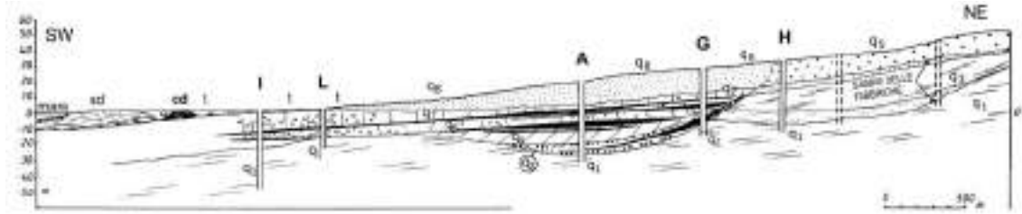
Figura 56 - Sezione geologica attraverso la pianura olocenica, il T. ZZ0II e il T. ZZ0I a Vada. Le sigle che contraddistinguono le diverse formazioni sono le stesse usate in Figura 54 e nel testo, tranne la sd (= al lido più esterno) e la cd (= al lido più interno), in nero i livelli argillosi (da Bartoletti et al., 1986). L'ubicazione dei pozzi è data in Figura 53.
