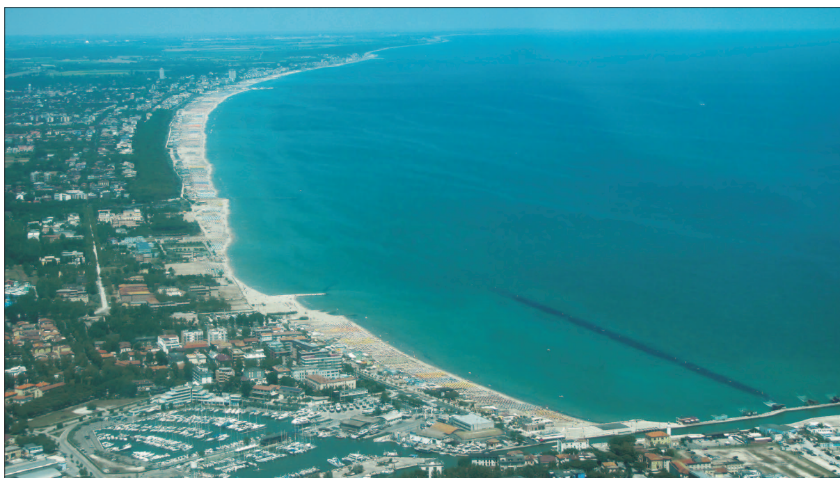
Figura 40 - Cesenatico Ponente: in primo piano, la scogliera semisommersa radicata al molo, il pennello di chiusura dei primi 800 m e la falcata erosiva più a nord; sullo sfondo, la spiaggia e il porto di Cervia.
