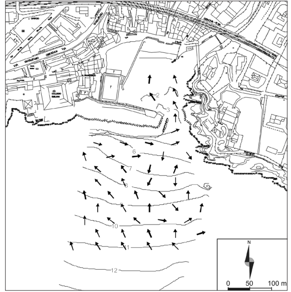
Figura 7 - Vettori di trasporto determinati secondo la metodologia proposta da Gao e Collins (1992).
