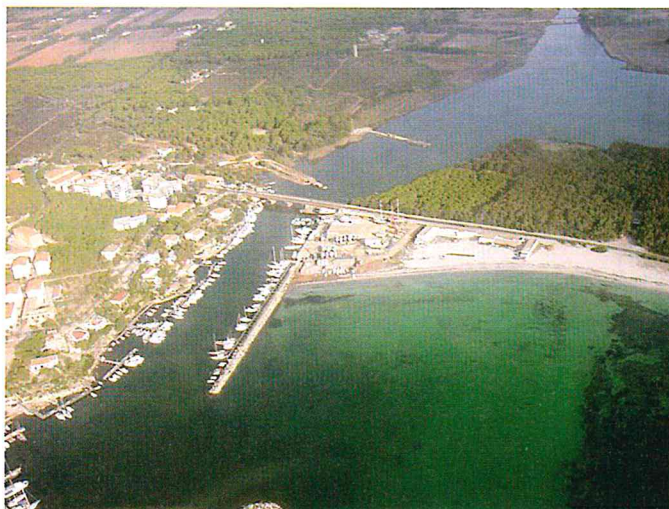
Figura 3 - Panoramica della bocca a mare dello Stagno del Calich, presso Fertilia, dove è evidente l’accumulo delle sabbie sul molo di Ponente del porticciolo turistico.
