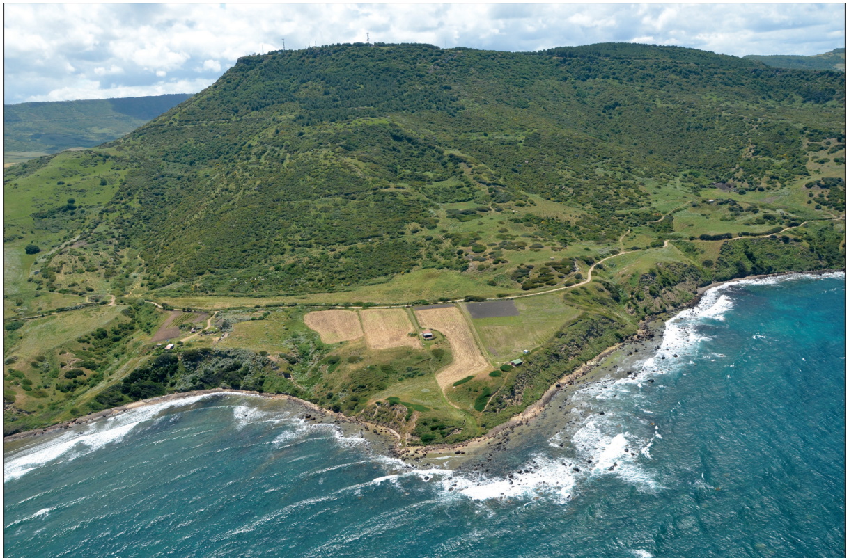
Figura 5 – Punta di Prima Guardia all'estremità orientale dell'area in studio. La falesia è impostata sulle eolianiti che ricoprono il vasto corpo della deformazione gravitativa di versante proveniente dal Monte Osoni. I grossi blocchi dell'ignimbrite vengono isolati dal moto ondoso sulla piattaforma attuale.
