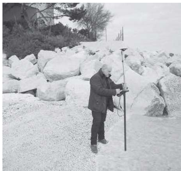
Figura 4. Fase del rilievo con GPS RTK.
