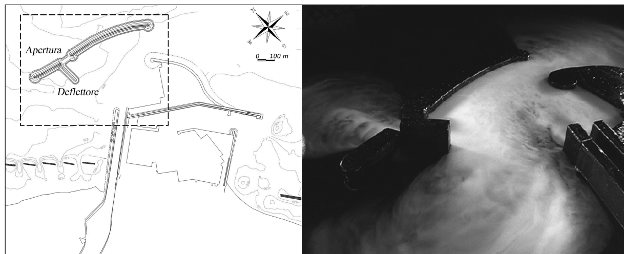
Figura 6 - Apertura nella diga foranea con deviatore di flusso per facilitare il deflusso delle acque fluviali verso il largo.
