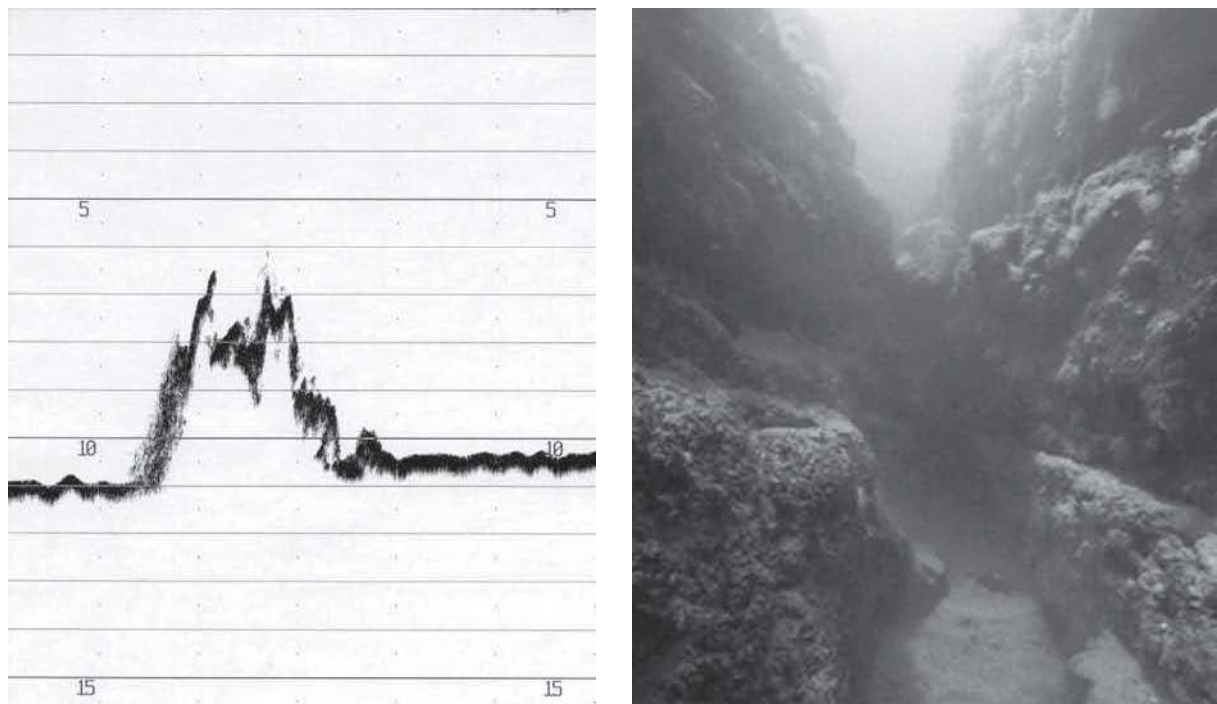
Figure 1 e 2. Lo scoglio del Trave in un profilo batimetrico eseguito con ecoscandaglio idrografico e in una immagine subacquea.
