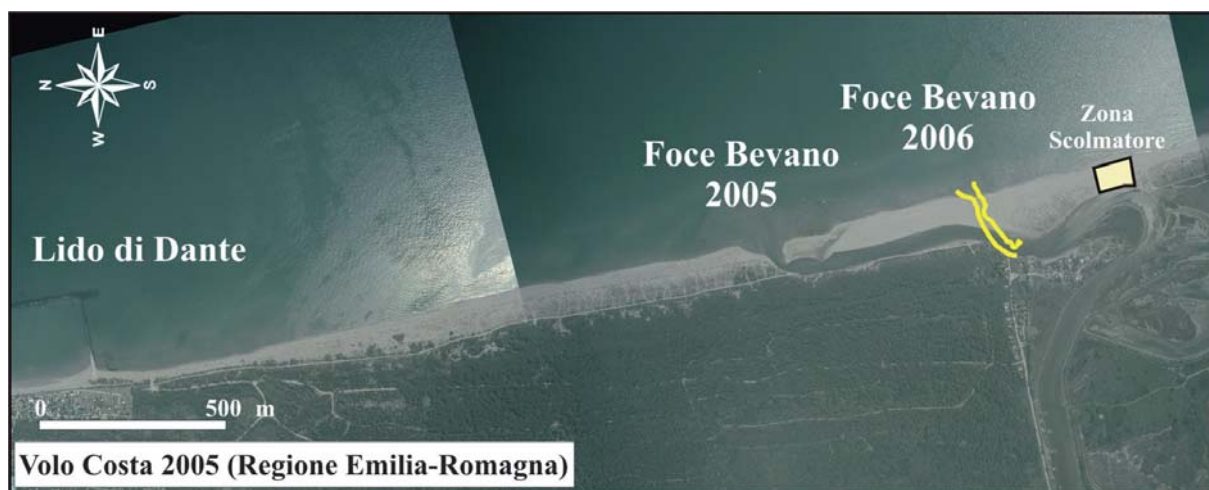
Figura 2 - Schematizzazione della posizione della nuova foce del T. Bevano, ricavata dal rilievo batimetrico del 21 aprile 2006 (base di riferimento: Volo Costa 2005, Regione Emilia-Romagna). Per "Zona Scolmatore" si intende un tratto di spiaggia con quota di fondo al medio mare, posizionata all'altezza dell'ultimo meandro.
